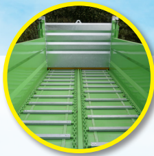
Przenośnik z przykręcanymi listwami i łańcuchami ogniwymi GR80
